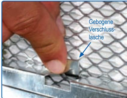
Formschlüssige Verbindung und Fixierung durch Umbiegen der Verschlusslasche
