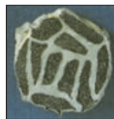
рис.3. Срез 5 жгутов Permasure®, которые, завулканизировавшись вместе, образовали единый монолит.
