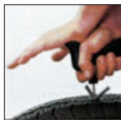
рис.2 Жгуты Permasure® можно легко установить, применяя спиральное шило и ручку для установки жгутов.
